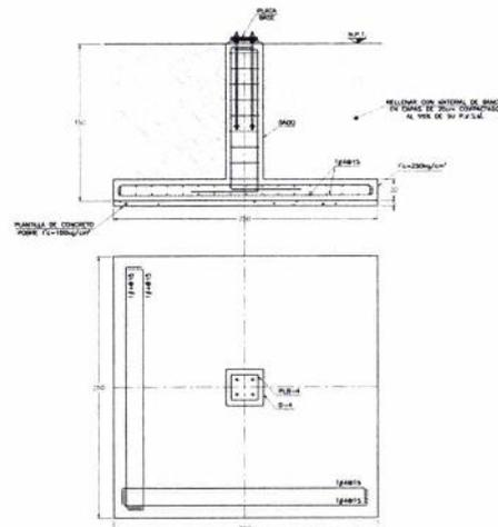
ESTRUCTURA DE HERRAJE PARA EL ANCLAJE DE COLUMNAS EN LOS NIVELES DE PLANTA DE CONCRETO SOBRE Fc=120kg/cm² EN CASO DE SER COMPROBADO AL TIRAR DE SU PUNTA.
